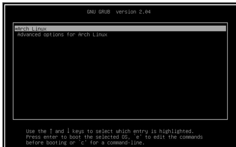
17 Bootloader, cargador de arranque responsable de cargar y transferir el control al kernel de un sistema operativo.
