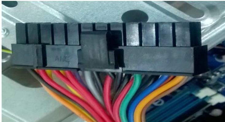
Imagen 5: Conector ATX de fuente de alimentación.
