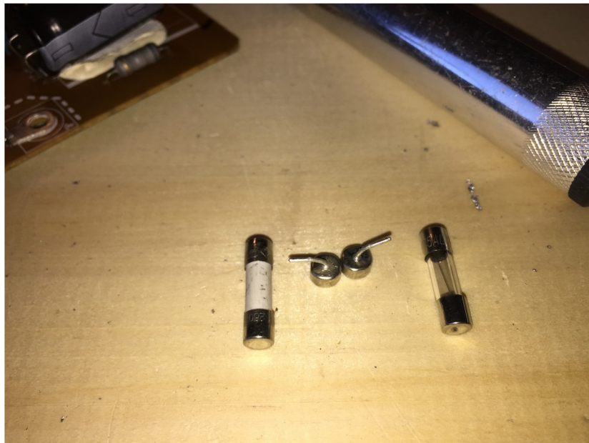
Figura 19. Fusible dañado a la izquierda, fusible nuevo a la derecha.
