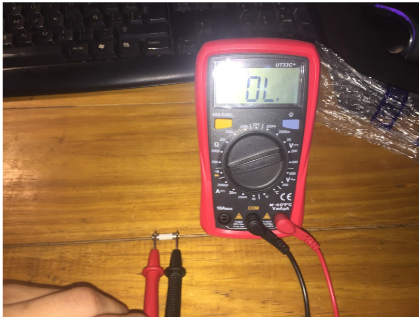
Figura 18. Medición nula de continuidad.
