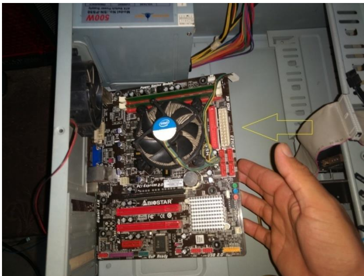
Ilustración 13: La flecha en la imagen indica el costado que se debe levantar para evitar romper los conectores.
