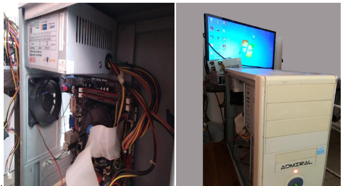
Ilustración 10: Una vez que testee la fuente, pase a colocarla en el CPU para realizar la prueba de encendido de todos los componentes de la PC
