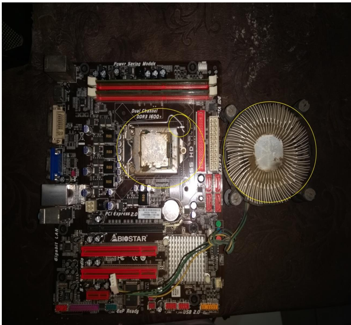
Ilustración 15: se señala con círculos mas grandes el estado en el que se encontraba el microprocesador y el disipador del mismo. y con un círculo más chico la traba para quitar el microprocesador.
