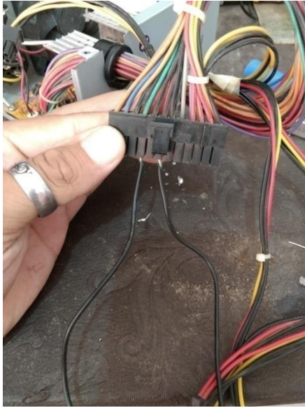
Ilustración 5 - En la imagen que sigue vemos el método de puenteo, y dichos pines.
