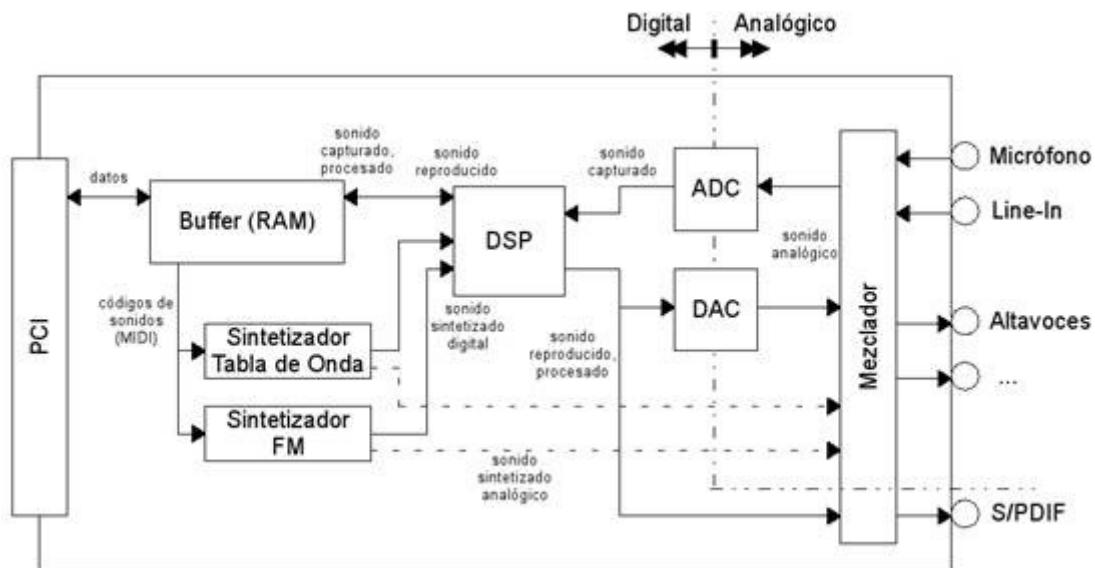
*El componente fundamental de las tarjetas de sonido es el chip sintetizador, el cual es capaz de generar ondas musicales permitiendo así que la tarjeta pueda reproducir/producir el sonido.*
