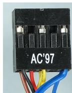
**AC'97:** Es un codificador de audio desarrollado por los laboratorios de Intel en 1997. Este estandar se usó en placas base, módems y tarjetas de sonido. Posee una arquitectura de alta calidad de 16 o 20 bits y admite una frecuencia de 96 kHz con una resolución estéreo de 20 bits para grabación y reproducción multicanal.
