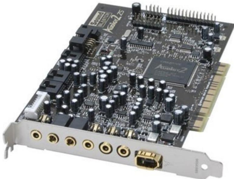
Físicamente es una placa rectangular de plástico plano que posee una serie de microcircuitos integrados en su superficie. Los conectores se encuentran en uno de sus extremos, el cual se inserta en una de las ranuras del ordenador (cuando este sea para computadoras de escritorio), logrando así que los conectores queden a la vista y sean accesibles al usuario.
