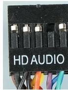
**HD Audio (Intel High Definition Audio):** Es un sucesor, el cual no es compatible con versiones anteriores de AC'97. Es una especificación publicada por Intel en 2004. Es capaz de reproducir más canales con mayor calidad que los códecs de audio integrados anteriormente. Éste posee un hardware capaz de entregar 192 kHz de calidad de 32 bits en dos canales y 96 kHz de 32 bits para un máximo de ocho canales.
