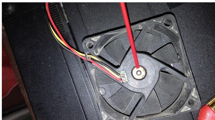
*Ilustración 9: Lubricamos aplicando solo una gota de lubricante en el centro y hacemos girar las aspas para que el lubricante penetre.*
