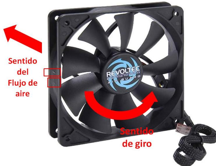
**Motor:** Es un electro imán que es el motor en sí, pero del otro lado posee un circuito de control, pudiendo tener en ocasiones un micro controlador completo. Posee dos partes, el electro imán (“coils”) y un sensor hall (“hall sensor”). El hall permite detectar la velocidad de giro del ventilador.
