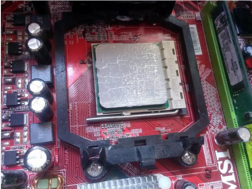
*Ilustración 3: Al retirar el cooler se podrá apreciar el microprocesador, para retirarlo levantamos la palanca que se encuentra a un lado*
