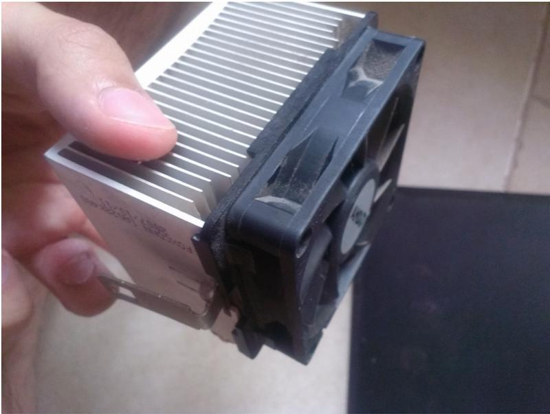
*Ilustración 5: Sacamos el disipador de su ventilador para una limpieza mas profunda*
