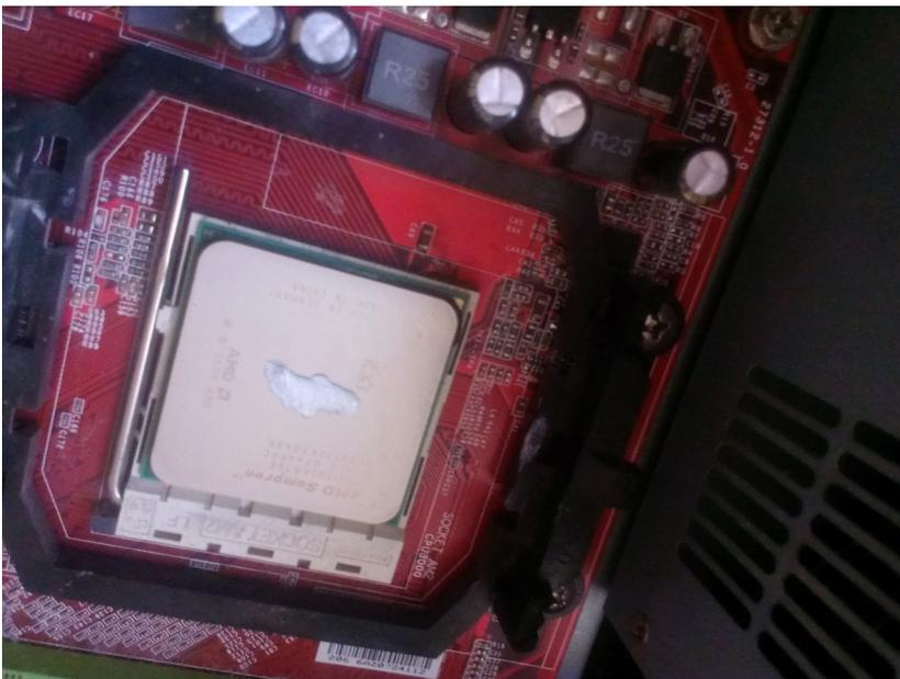
*Ilustración 6: Para terminar, procedemos a colocar el microprocesador en el socket y le aplicamos pasta térmica.*
