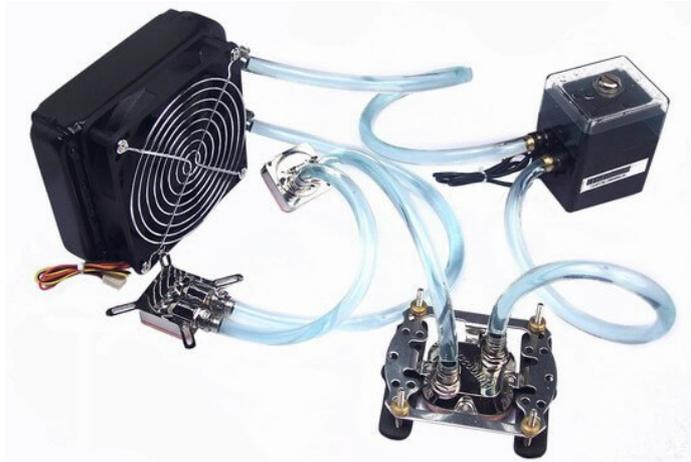
Y por ultimo la refrigeración **liquida “activa”**, es construida del mismo modo que la “pasiva” pero el calor almacenado por el disipador es expulsado por los ventiladores puestos sobre estos disipadores, permitiendo alcanzar un delta muy cercano a cero ( $\Delta T = \text{Temperatura del componente} - \text{Temperatura del ambiente}$ ).
