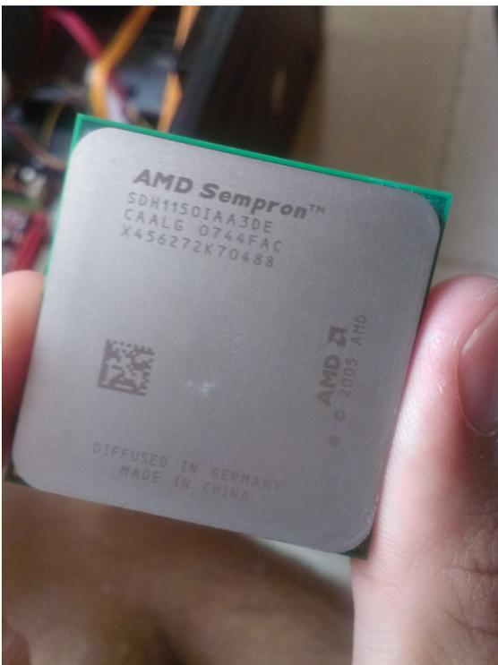
*Ilustración 4: Una vez retirado el microprocesador del socket, limpiarlo bien con estopa*
