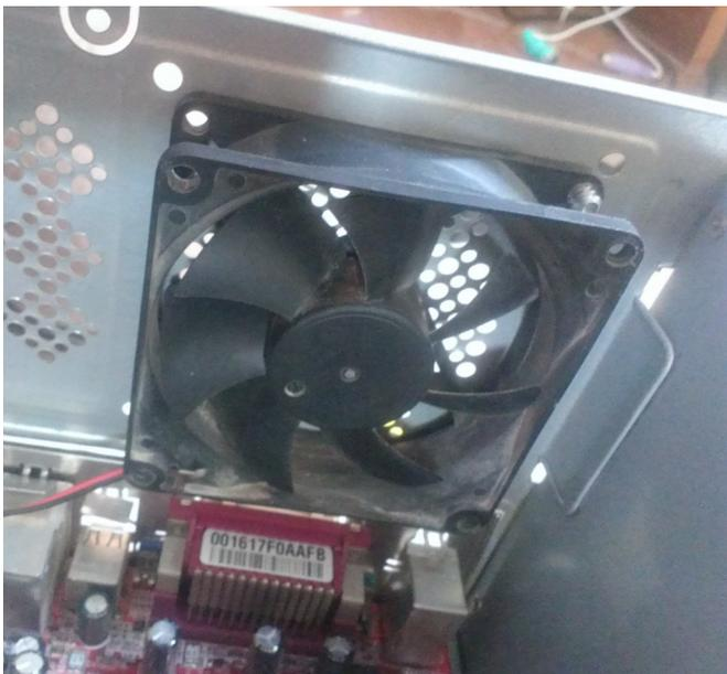
*Ilustración 10: Presentamos el ventilador a nuestro gabinete para comprobar si coinciden los agujeros*
