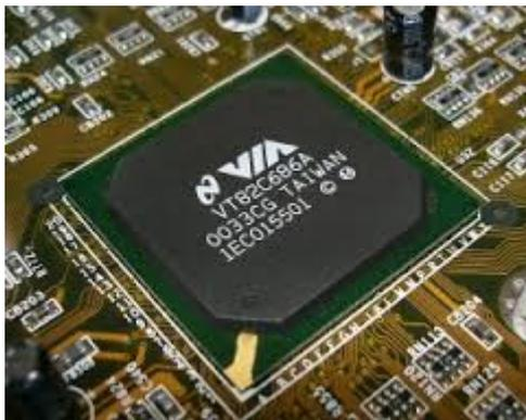
Independientemente de cómo están conformados, es importante definir cuál es la estructura clásica de un chipset, la que está compuesta por dos elementos principales. Primeramente se encuentra el puente norte o northbridge y luego el puente sur o southbridge. El puente norte es el más importante y tiene la funcionalidad de conectar entre sí a los componentes principales que determinan la capacidad de proceso de una
