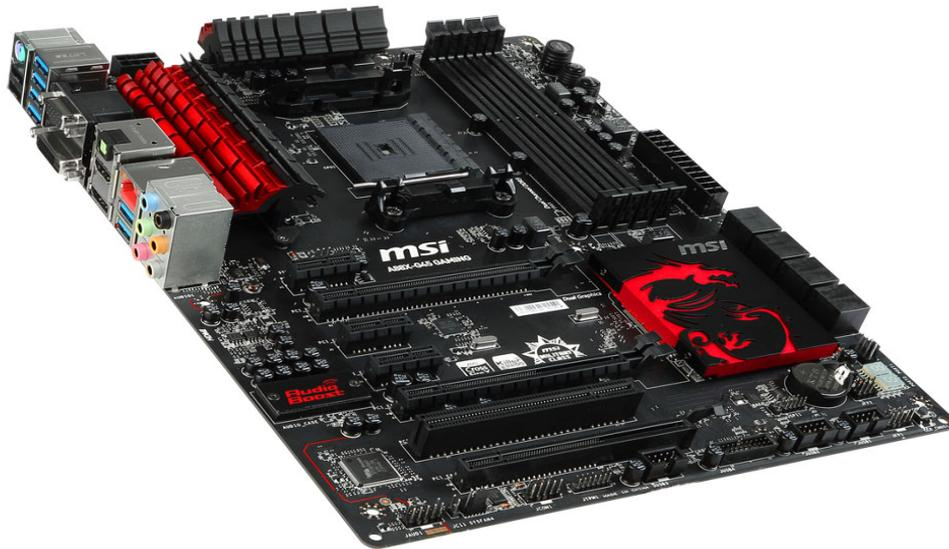
El A88X-G45 GAMING cuenta con tres slots PCI Express x16, por lo que soporta CrossFire con hasta tres tarjetas gráficas Radeon. La velocidad real de los slots PCIe es de: x16 para el primero, x8 para el segundo y para el último x4.
