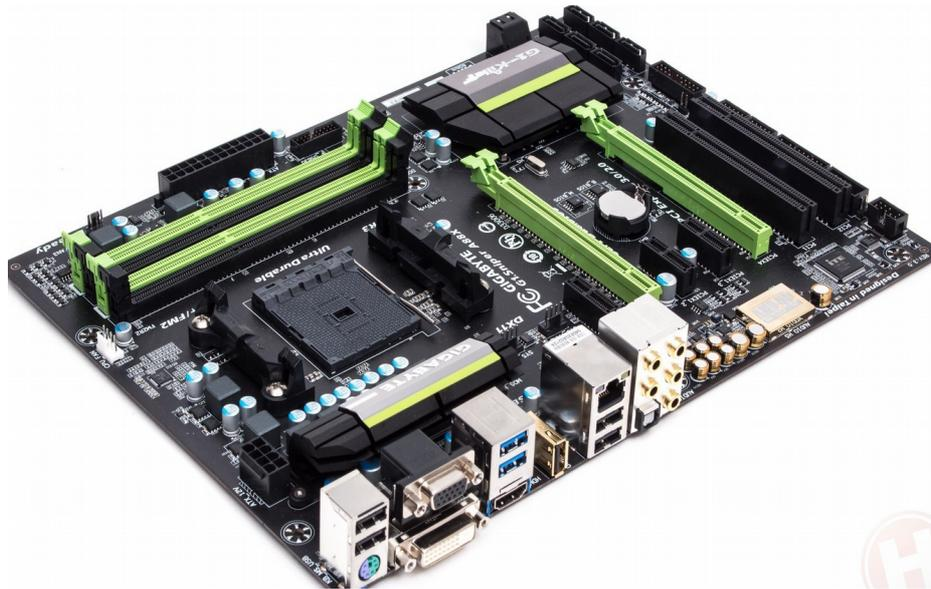
Si se opta por usar vídeo integrado, el Motherboard cuenta con las siguientes salidas necesarias: DVI, HDMI y VGA. En el panel trasero se dispone de dos puertos USB 3.0 y cinco puertos USB 2.0. Uno de los cuales es dorado, lo que indica que esta configurado para proveer una señal súper limpia, ideal para conectar dispositivos sensibles (como puede ser placa de sonido externa).
