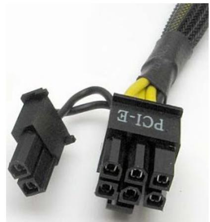
Existen Placas de Video que tienen un consumo de 75W y no necesitan ningún cable de alimentación extra, así como también existe otras que pueden llegar a necesitar hasta 2 o mas cables extras, todo dependiendo del modelo y el fabricante.
